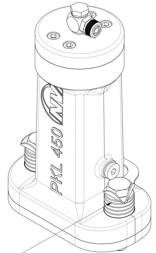
Der Befestigungssatz NBS ermöglicht eine dauerhafte und betriebssichere Befestigung des Druckluft-Intervallklopfers. Die Verwendung des Befestigungssatzes NBS zur Montage des PKL ist vorgeschrieben.
